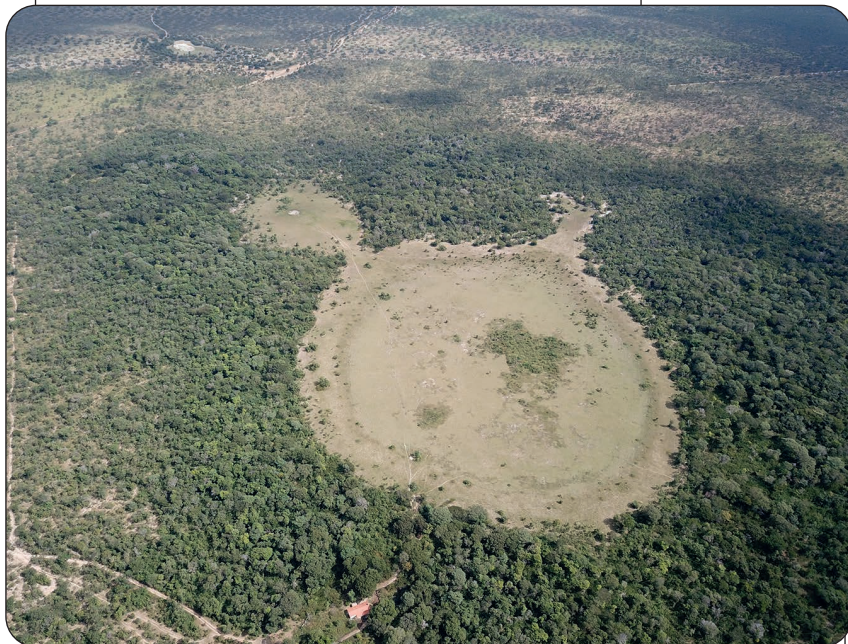
Figure 4.5. Exemple de structure circulaire productrice d'hydrogène au Brésil. On note l'impact sur la végétation.
