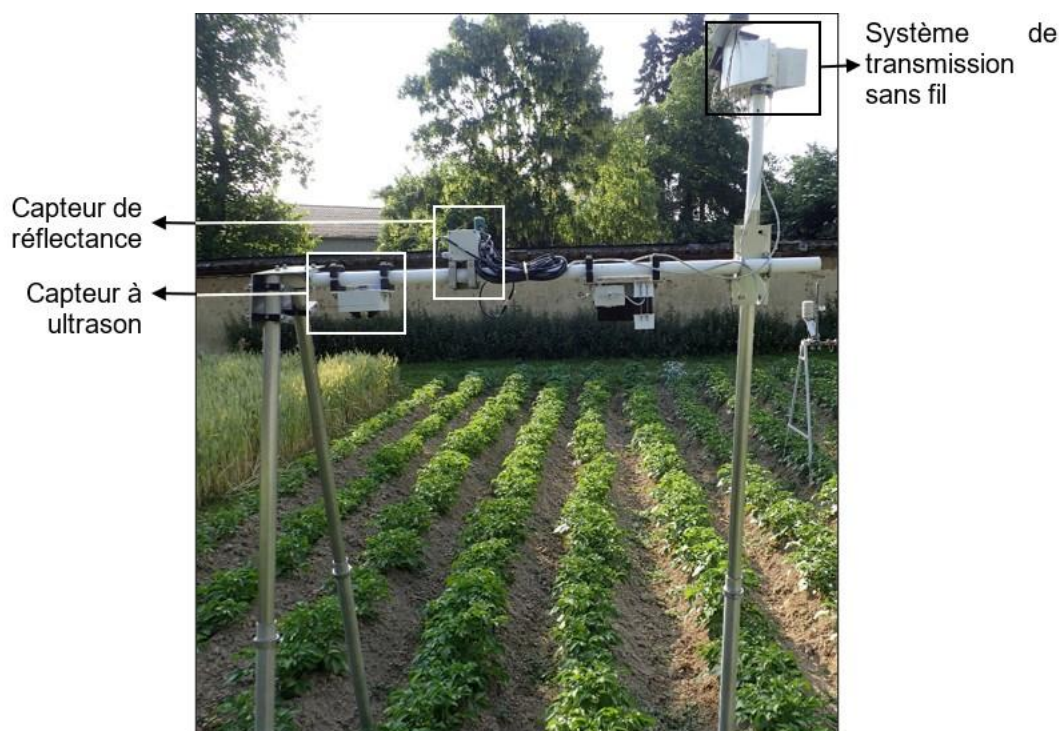
Figure 2 : Portique sur lequel ont été positionnés les différents capteurs à ultrasons et de réflectance pour suivre le développement foliaire des plantes ainsi que le système de transmission sans fil pour un suivi en temps réel. Photo © INRAE
