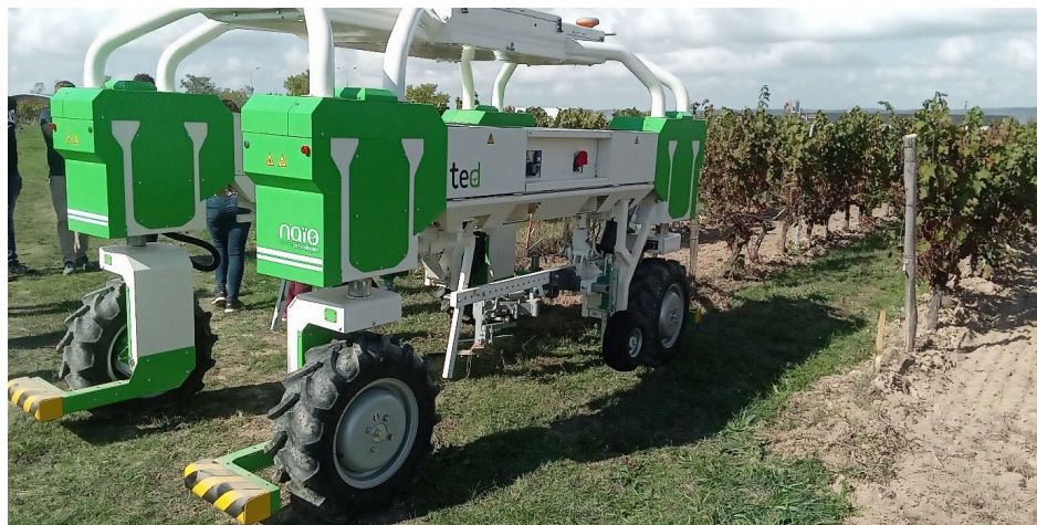
Photo 2 : Version 2 du robot Ted, déployé sur le site de Gaillac à partir de juin 2022, équipé d'interceps mécaniques Perrein, crédit photo IFV CG
