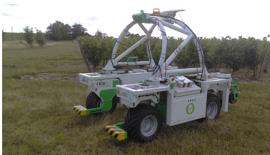
Photo 1 : Robot Ted (Version 1) de la société Naïo Technologies, équipé des interceps mécaniques Vitimeca, crédit photo IFV CG
