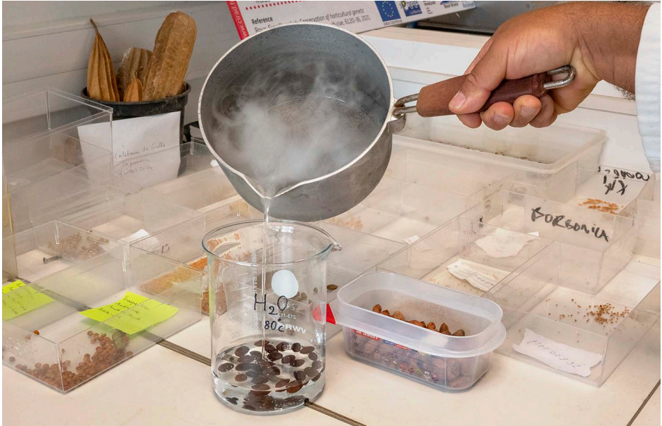
Scarification thermique de graines.
