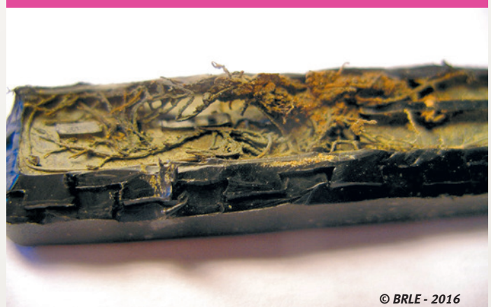
2 Intrusion racinaire dans un goutteur sur un verger de pêchers.
