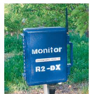
❷ Tensiomètres et monitor utilisés pour le suivi de la disponibilité de l'eau dans le sol.
