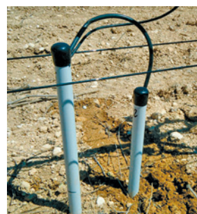
❷ Tensiomètres et monitor utilisés pour le suivi de la disponibilité de l'eau dans le sol.
