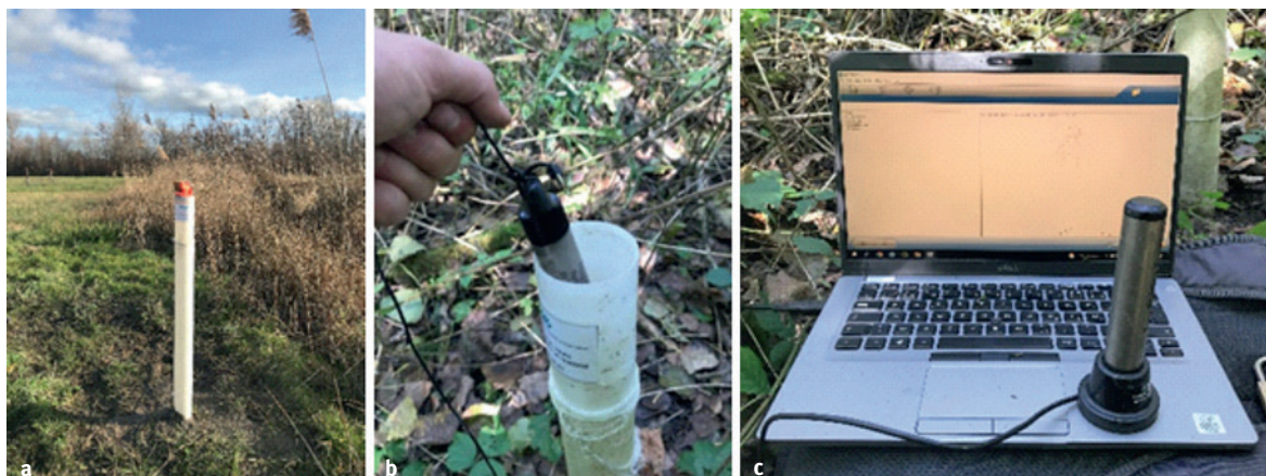
Figure 1 – Exemple d'une installation type d'un piézomètre (a) comprenant un tube PVC crépiné entouré par un géotextile afin d'éviter le colmatage du tube par des sédiments fins, un bouchon supérieur et un cadenas de verrouillage de l'installation, (b) une sonde autonome d'enregistrement des profondeurs de nappe suspendu par une cordelette âme Kevlar dans le tube. Pour ce type de sonde, les données sont extraites via un socle de communication USB sur lequel est placé la sonde et un ordinateur portable comprenant le logiciel du fournisseur. Crédit photographique : Hugo Clément (INRAE).
