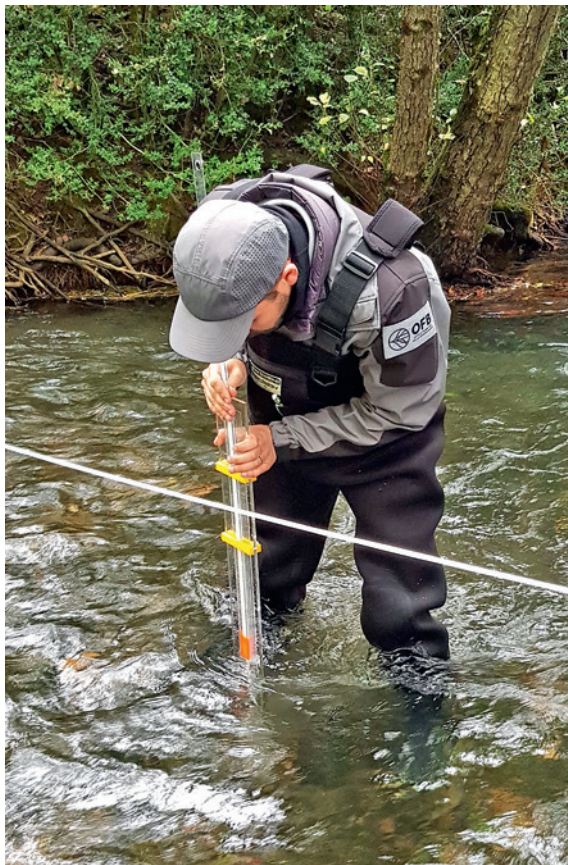
Photo 1 – Déploiement d'une perche à charge dynamique sur le Durzon à Nant (Aveyron) lors d'une formation à la mesure du débit minimum biologique. Crédit photographique : G. Dramais.
