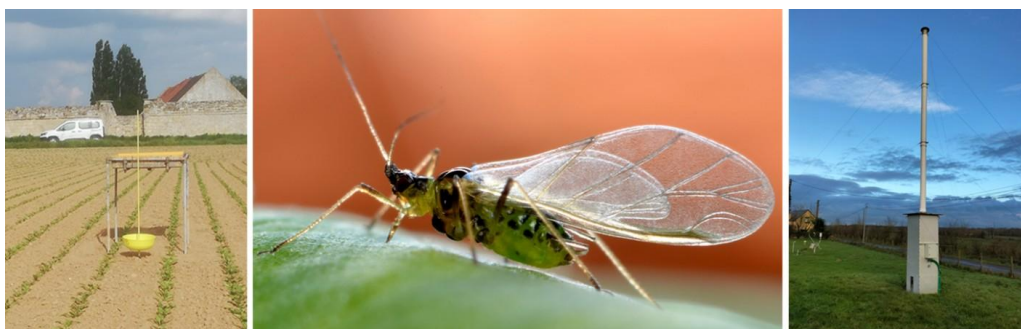
Figure 1 : Dispositifs d'échantillonnage aérien des pucerons vecteurs. A gauche , petit bac jaune (au premier plan) et grand bac jaune (en arrière-plan), placés dans une parcelle de betterave (Rouvillers, Oise), Crédit Photo : Jean-Christophe Simon. Au milieu , individu ailé du puceron vert du pêcher, Myzus persicae . Crédit Photo : Bernard Chaubet. A droite , piège à succion de 12,2 m qui aspire en permanence le plancton aérien, dont les pucerons en vol. Ce piège est situé au Rheu (Ile et Vilaine), sur le domaine du centre de recherche INRAE de Rennes, Crédit Photo : Franck Duval.
