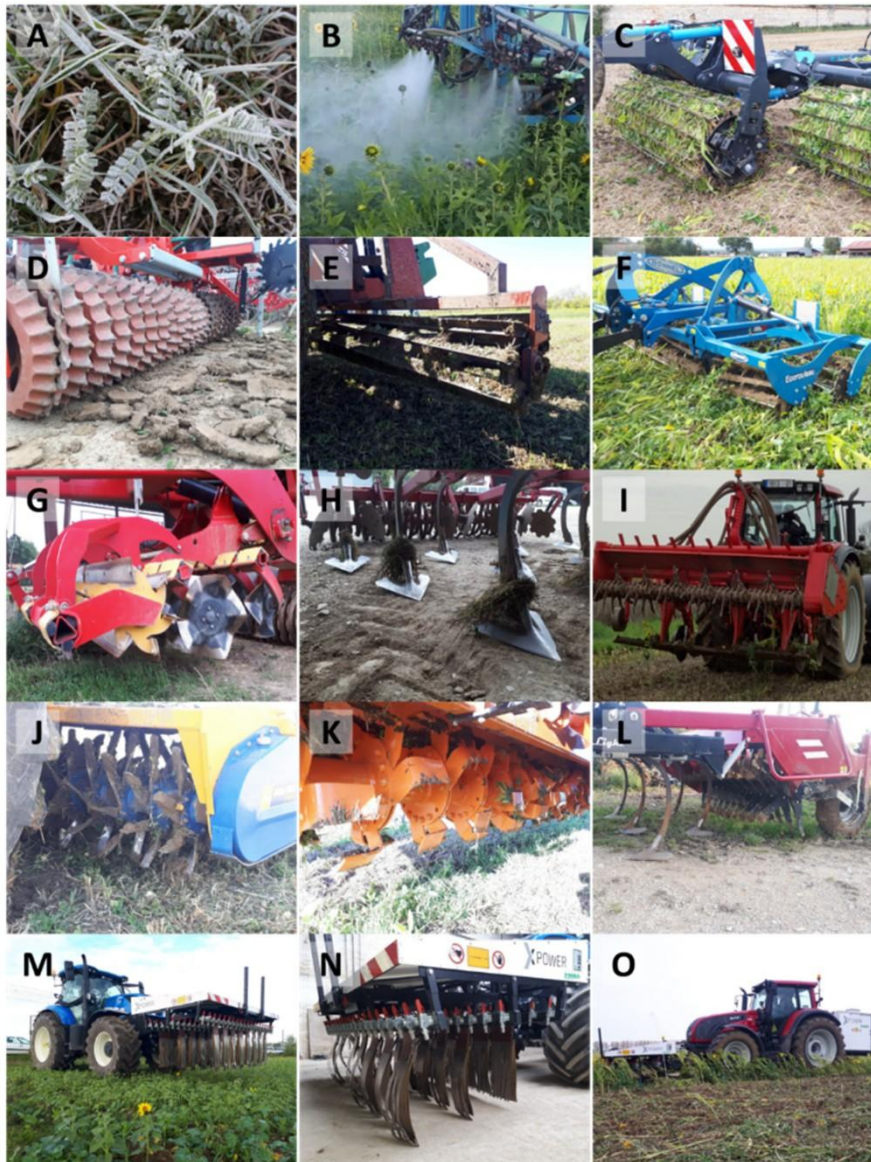
Figure 7 : Présentation photographique des différents outils testés sur les essais. A. Témoin gel, B. Bioherbicide, C. Rouleau hacheur Sacho Geacut 600, D. Rouleau Güttler, E. Rouleau faca auto-construit, F. Ecorouleau Bonnel, G. Carrier-Väderstad avec cross cutter, H. Terrano Horsch + pattes d'oie, I. Glyph-O-Mulch Ecomulch, J. Dynadrive Bomford, K. Fraise Bio GL 3000 FALC, L. Kwick-Finn 2020, M-N-O. Zasso Electroherb. © Stéphane Cordeau - INRAE – 2021
