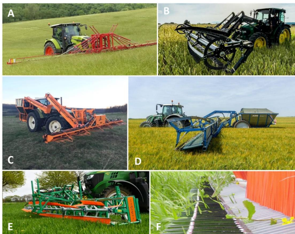
Figure 1 : Ecimeuse par couteaux rotatif sur relevage avant (A, Micheletti, crédit : Meneguzzo, www.meneguzzo.eu ) ou à rabatteur et section sur le chargeur frontal (B, Zürn, Crédit : Risag, www.zurnuk.co.uk ) ; Export des parties coupées par l'écimeuse portée frontale (C, Bionalan, crédit : Bionalan) ou trainées (D, Zürn, crédit : Willy Deschamps, www.tema-agriculture-terroirs.fr ) ; Ecimage sélectif sous la hauteur de la végétation (E et F, CombCut, www.lyckegardgroup.se ).
