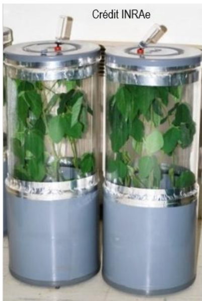
Photo 2 : Dispositif de mesure de l'activité de réduction de N 2 O en serre.
