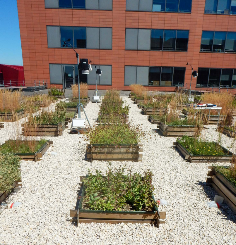
Figure 29.1. Expérience sur les toitures végétalisées visant à tester l'effet de la diversité végétale, de la nature et de la profondeur du substrat sur différentes fonctions écologiques : production de biomasse, rétention de l'eau, etc. (crédits : Yann Dusza).
