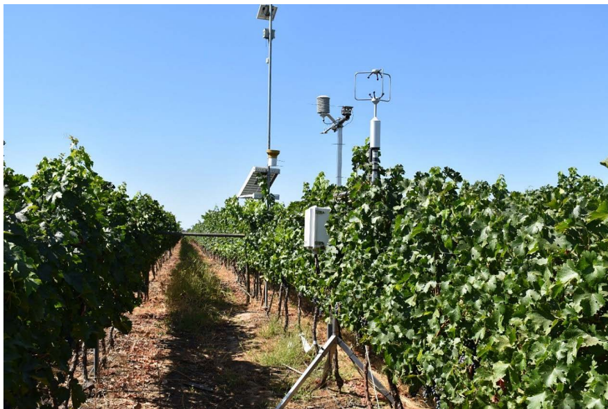
Photo 2.7. Vignoble contrôlé avec le système EC avec anémomètre sonique utilisé pour les mesures de covariance tourbillonnaire, ou eddy covariance EC (source : Fruition Sciences).
