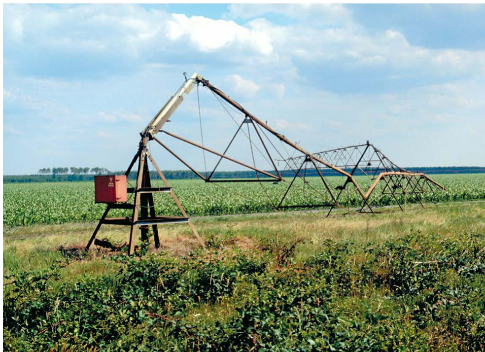
Photo 4.10. Affaissement d'un appareil suite à la corrosion et à l'érosion de la canalisation.
