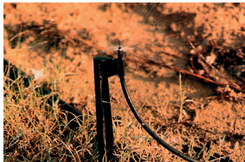
Photo 5.12. Mini-diffuseur relié à la rampe par un tube conducteur.
