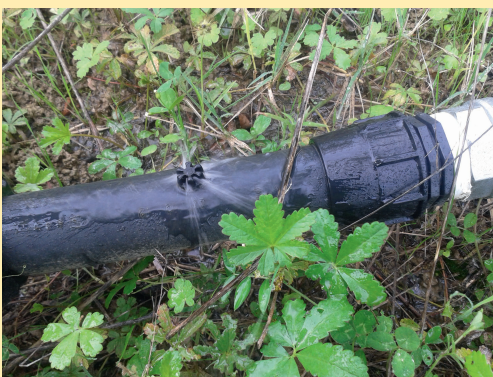
Photo 5.13. Dispositif d'irrigation par ajutage calibré (5.13 droite : © INRAE/B. Molle).
