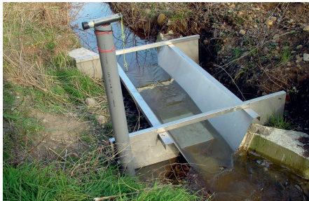
Photo 6.14. Mesure du débit à l'aide d'un seuil jaugeur (© F. Charron).
