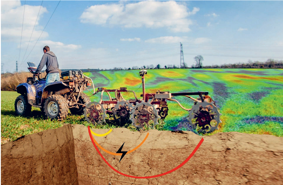
Photo 2.8. Exemple d'un système tracté utilisé pour les mesures de résistivité à grande échelle spatiale (© Geocarta).
