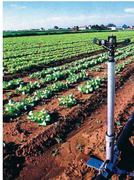
Photo 4.4. Canne utilisée en couverture intégrale (source : Irrifrance).
