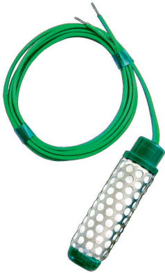
Photo 2.3. Tensiomètre à résistance électrique à connecter à une station d'acquisition automatique ou à un boîtier de lecture (© Sté Irrrometer) ; ce tensiomètre est le plus souvent disponible monté sur un tube PVC pour faciliter son utilisation.
