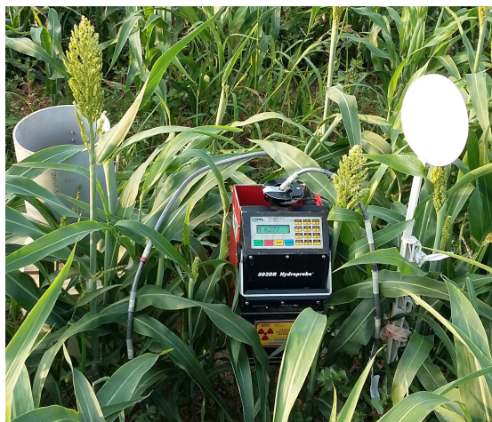
Photo 2.1. Sonde à neutrons sur son tube d'accès dans une parcelle de sorgho (© INRAE/C. Dejean).
