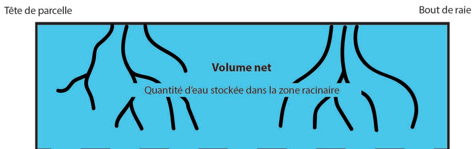
Figure 6.2. Une partie de l'eau provenant de la raie peut être absorbée par les racines, celle stockée dans la zone racinaire (illustration A. Rossel).
