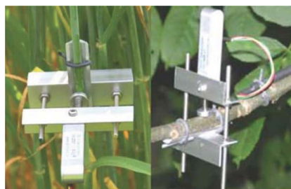
Photo 2.6. Illustration d'un dendromètre positionné sur des branches ou tiges de petit diamètre (© ES France, https://www.es-france.com/9229-dendrometre-arbre-et-plante-petit-diametre-dd-s1-et-dd-s2.html ).
