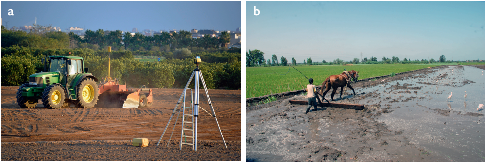
Photo 6.10. Planage d'une parcelle avec guidage au laser (a : © F. Rossel, Valence, Espagne) et attelé (b : © IRD/F. Molle).
