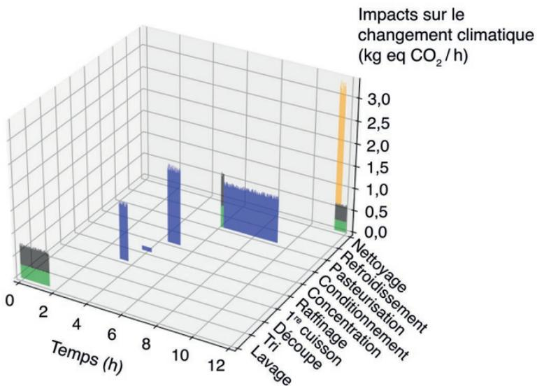
**Figure 4.** Impacts dynamiques du changement climatique calculés par la méthode « Environmental Footprint version 3.0 (EF3.0) » dans le cas d'un procédé discontinu de production de purée de tomate.
