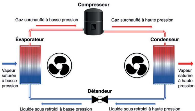
**Figure 5.** Circuit de réfrigération à compression de vapeur.
