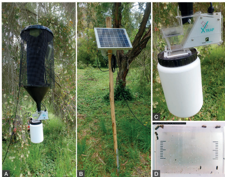
Figure 15.5. A) Piège à coléoptères équipé du système de détection automatique SamFix. B) Alimentation autonome photovoltaïque. C) Détail du module. D) Exemple de cliché avec identification automatique des scolytes capturés (© A. Roques).
