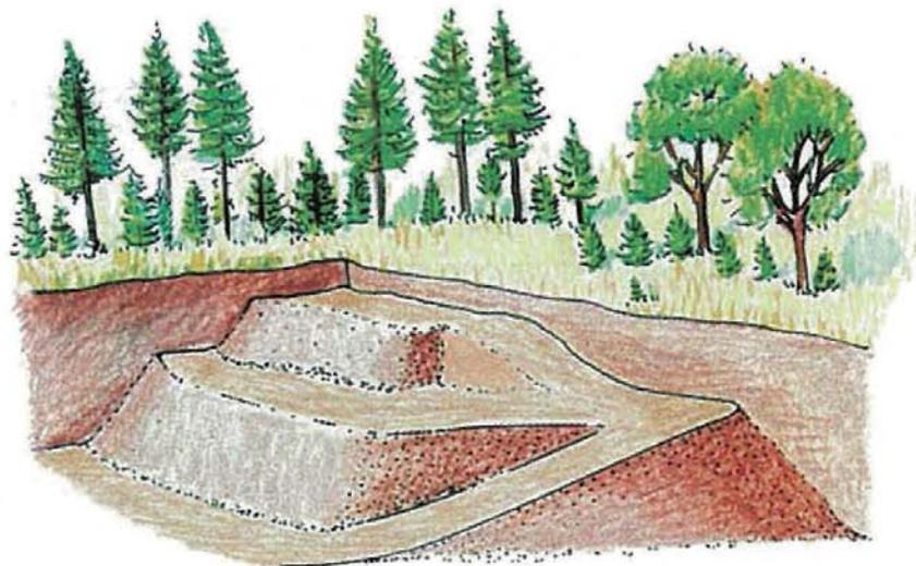
Figure 35 : Schéma d'un remblayage en terrasse (d'après [5]).
