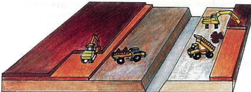
2 – Décapage de la terre végétale d'une nouvelle bande et mise en place à la pelle mécanique sur l'horizon minéral
