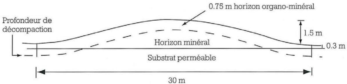
Figure 40 : Modelé du terrain en billons (d'après [92]).
