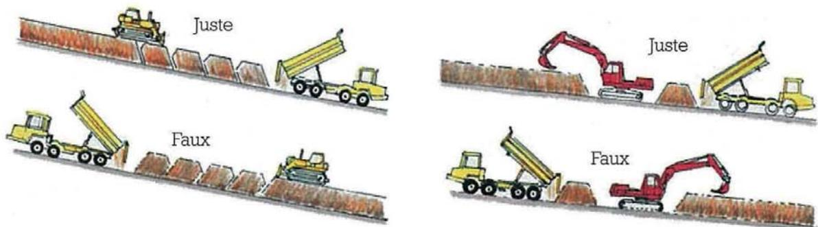
Figure 39 : Mise en place du sous-sol de haut en bas (d'après [62 a]).
