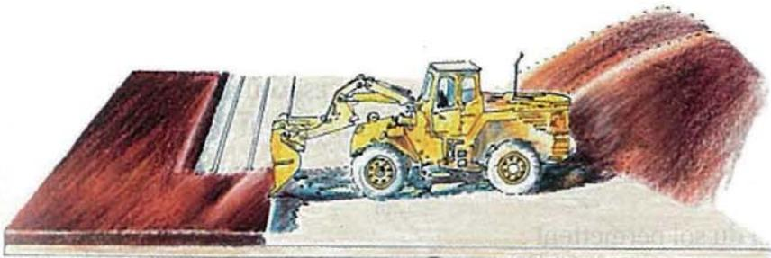
3 – Dépôt de la terre et réglage grossier, godet manipulé en rétro.
