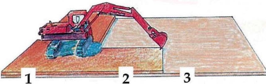
2 – Régalage de la couche inférieure par une pelle montée sur chenilles, circulant sur la bande 1 terminée ; travail presque exclusivement en rétro.
