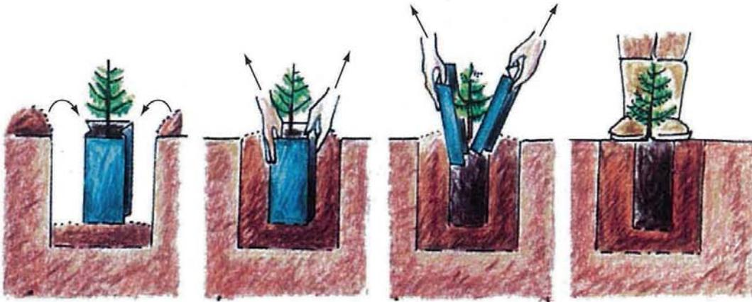
Figure 54 : Plantation d'un plant en conteneur en potet [27].
