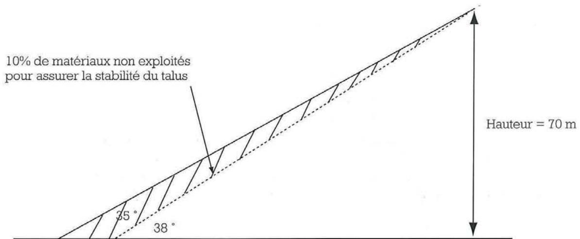
Figure 62 : Réduction de la pente d'un talus et perte en matériau [F14 Mo].
