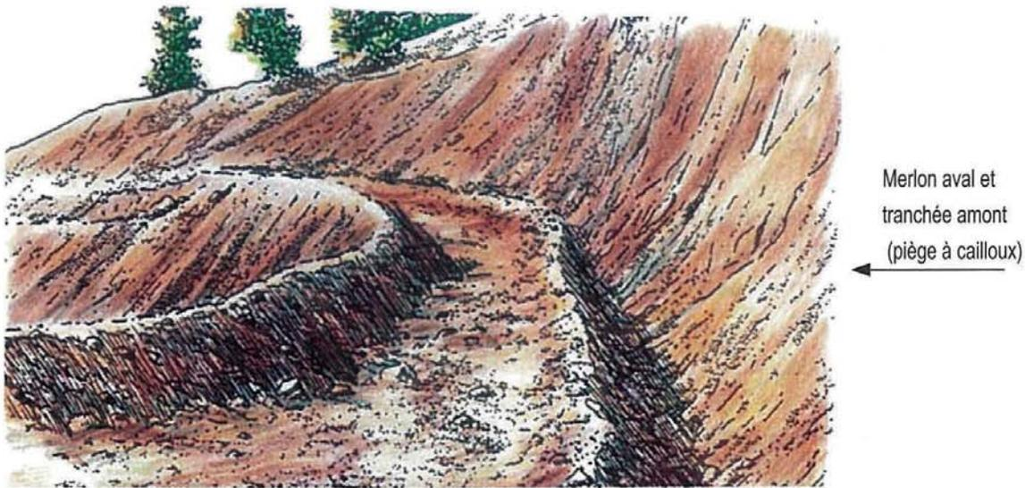
Figure 69 : Banquette en préparation avec merlon aval et tranchée amont [TPG 11].
