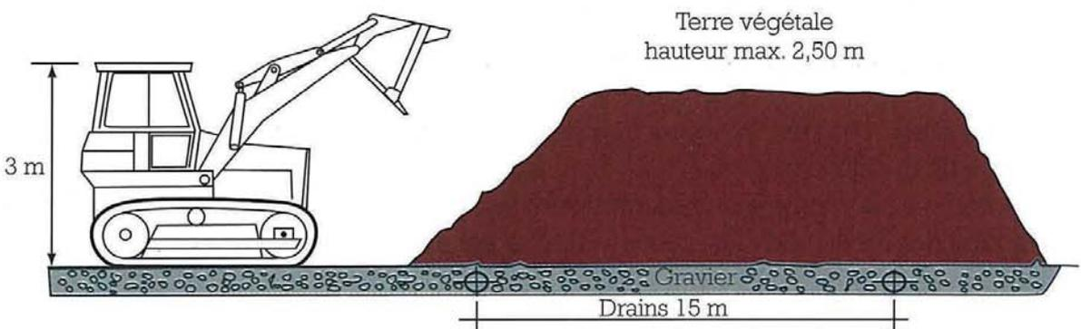
Figure 16 : Préparation d'un site de stockage sur un sol imperméable (d'après [62a]).
