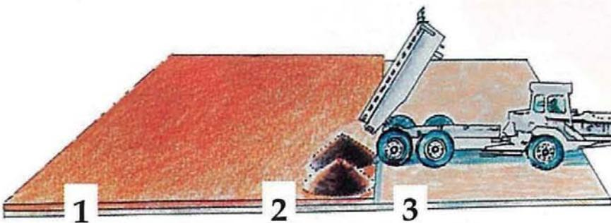
3 – Apport de la couche supérieure sur la bande 2. Le bennage doit être fait sur la couche inférieure, quitte à monter les roues arrière, pour ne pas gaspiller la terre sur le soubassement de la bande 3.
