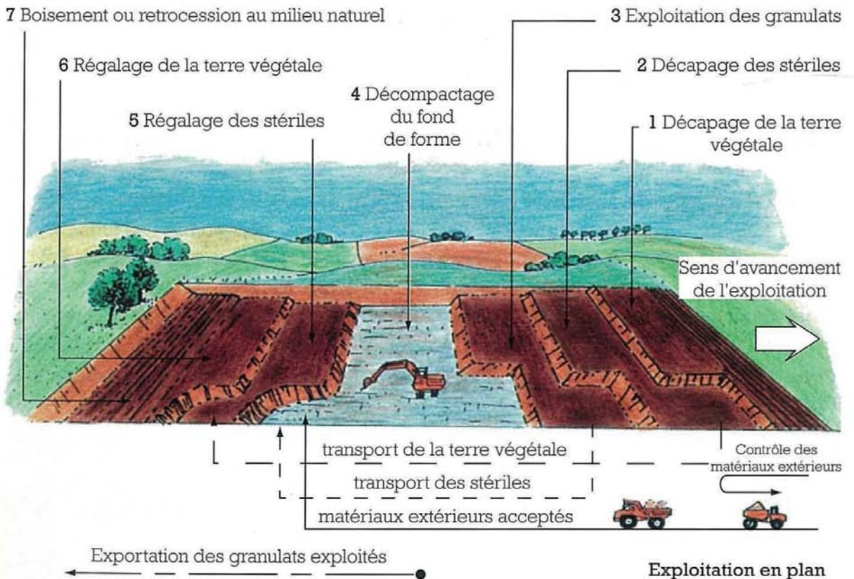
Figure 29 : Schéma d'un réaménagement forestier à l'avancée.
