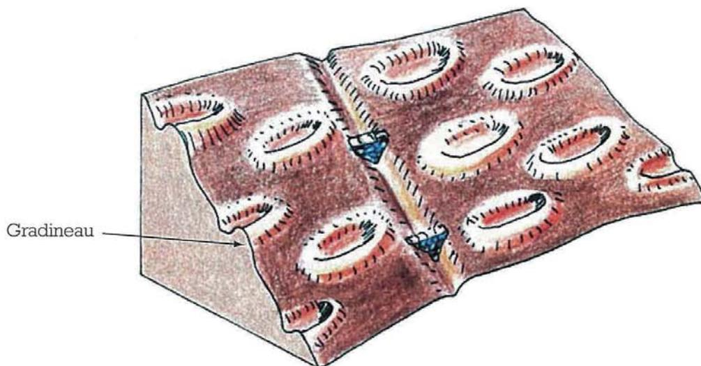
Figure 85 : Réalisation de petits gradins sur une pente [27].
