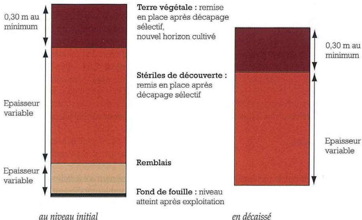
Figure 32 : Schéma d'un profil de sol reconstitué.
