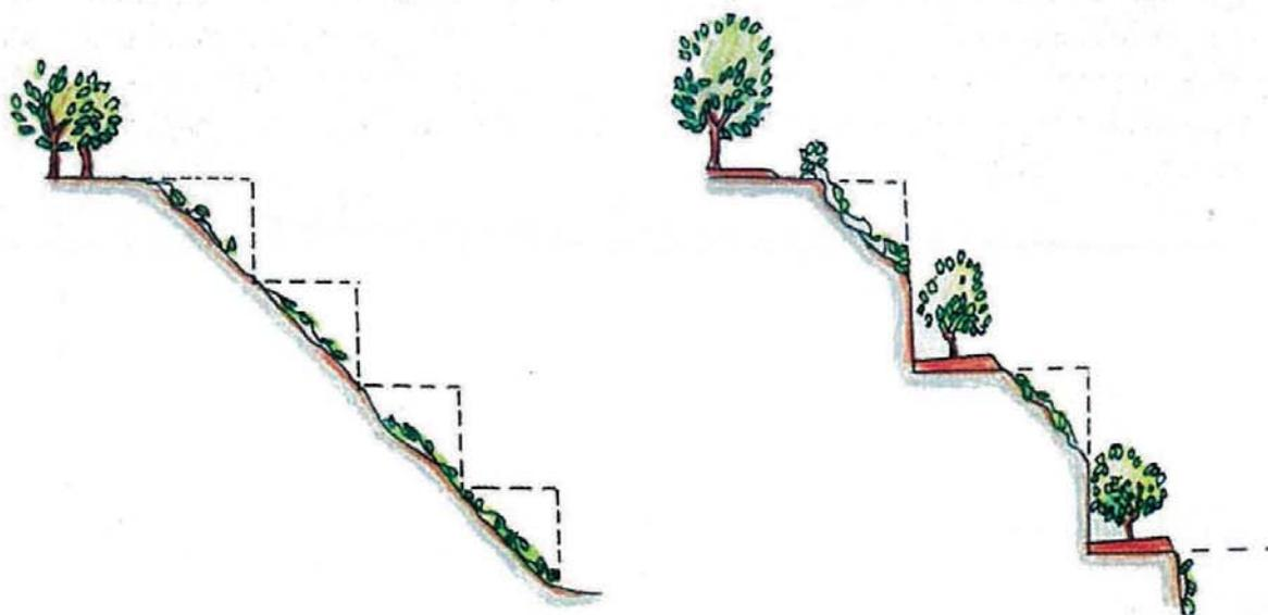
Figure 64 : Profils rectifiés par écrêtage de gradins [75].
