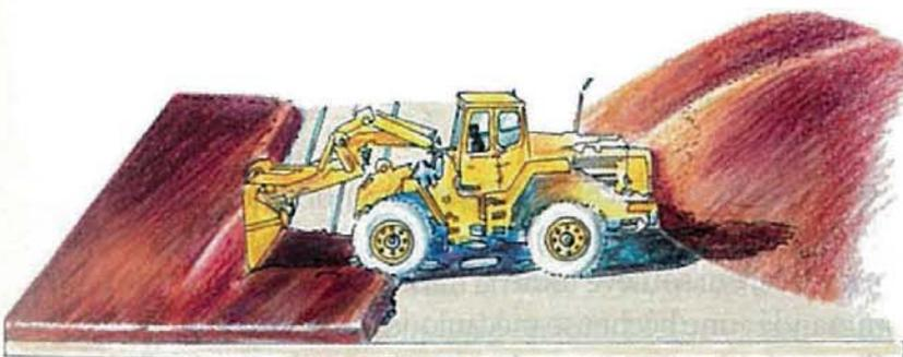
4 – Finition du réglage de la terre avec le godet du chargeur.
