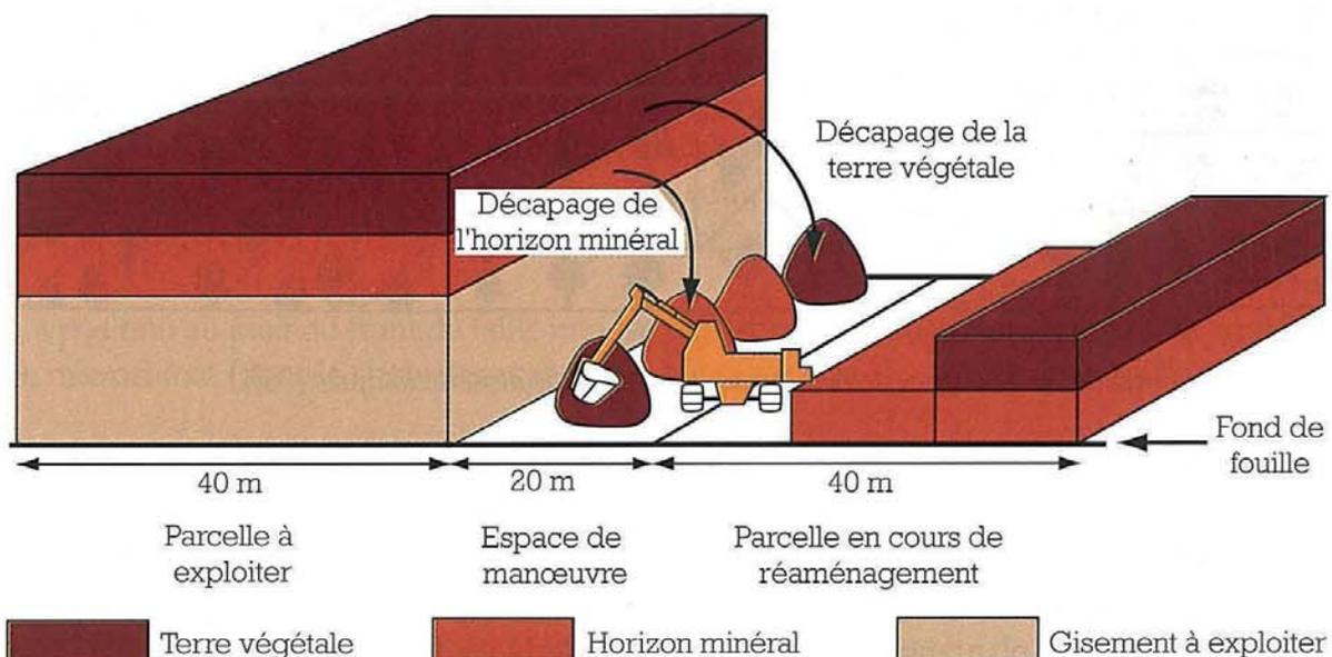
Figure 30 : Schéma de décapage pour faciliter les manœuvres.
