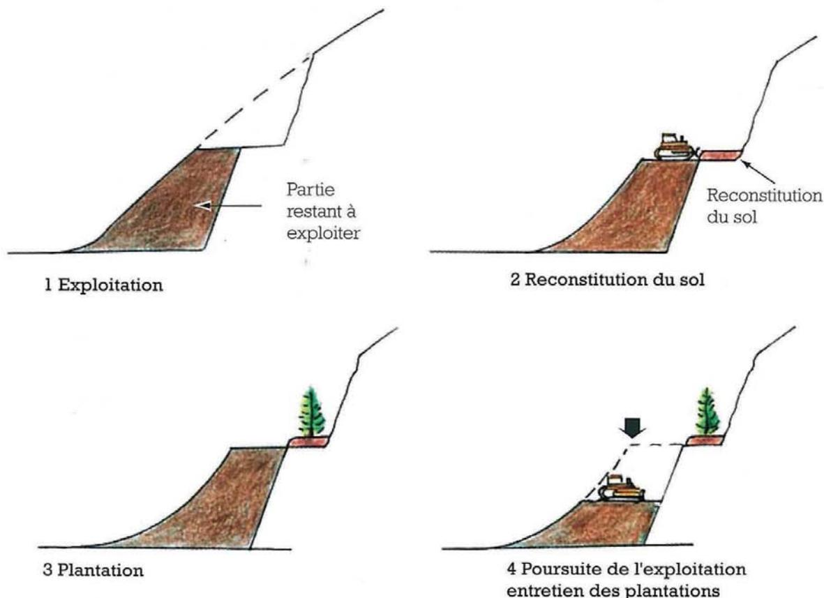
Figure 61 : Végétalisation d'une banquette en cours d'exploitation [75].
