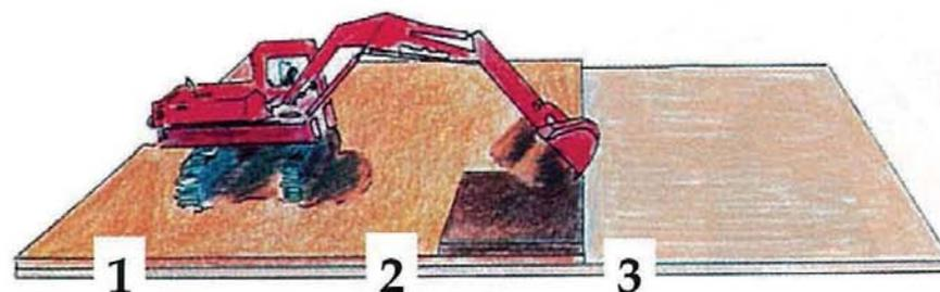
4 – Régalage de la couche supérieure par une pelle montée sur chenilles circulant sur la bande 1 terminée. Travail aisé en rétro, y compris pour la reprise de terre versée éventuellement sur le soubassement.
