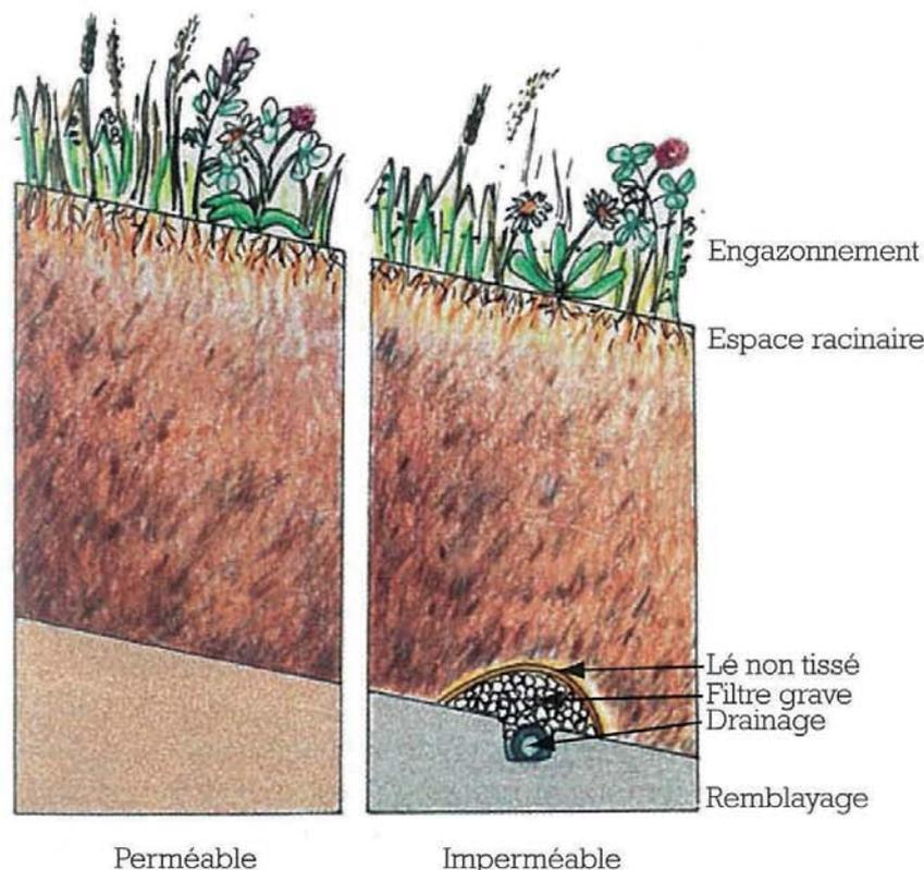
Figure 36 : Réalisation d'un collecteur sur un remblai imperméable [5].
