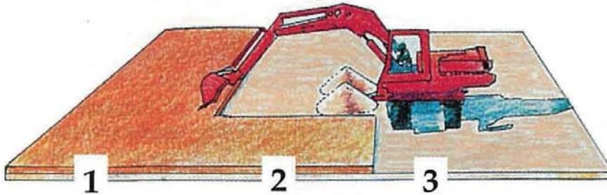
2 – Régalage de la couche inférieure par une pelle montée sur pneus, depuis le soubassement de la bande 3. Travail du godet en poussée puis finition en rétro.
