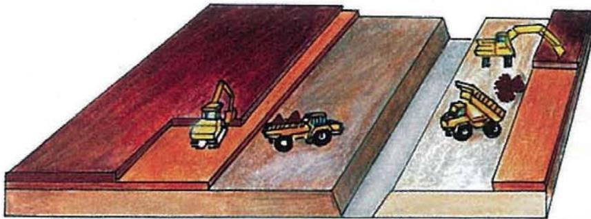
1 – Décapage de l'horizon minéral et mise en place sur le soubassement préparé
