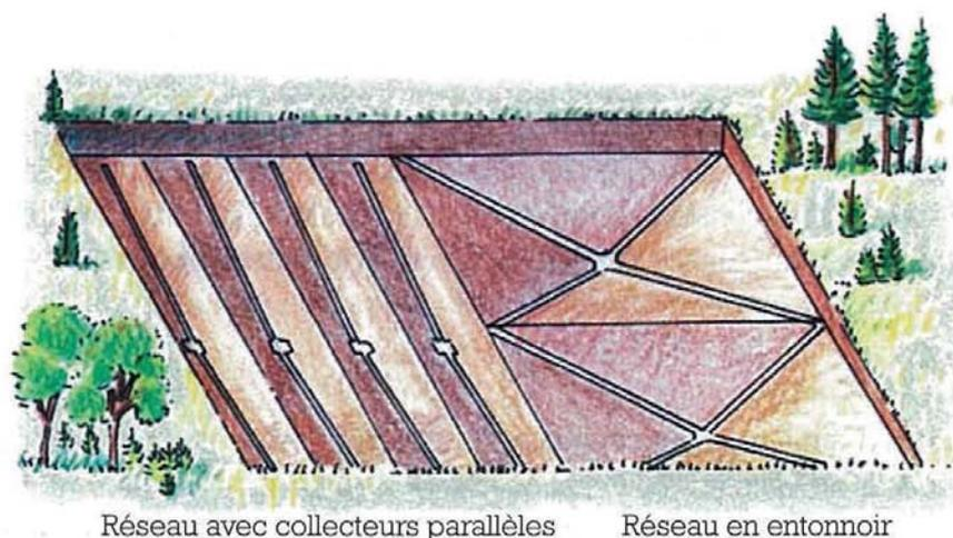
Figure 37 : Modélage d'un toit de remblai plat pour évacuer les eaux d'infiltration [5].
