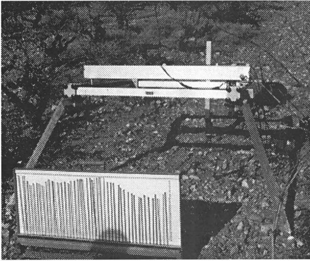
**Figure 1.** Profilomètre et profilographe LASER. Au premier plan, le profilomètre à aiguille, à l'arrière plan le profilographe LASER. Sol caillouteux en pente entre deux rangées de vigne.
