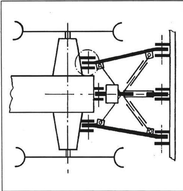
**Figure 3.** Chaînes croisées de stabilisation des bras inférieurs.
