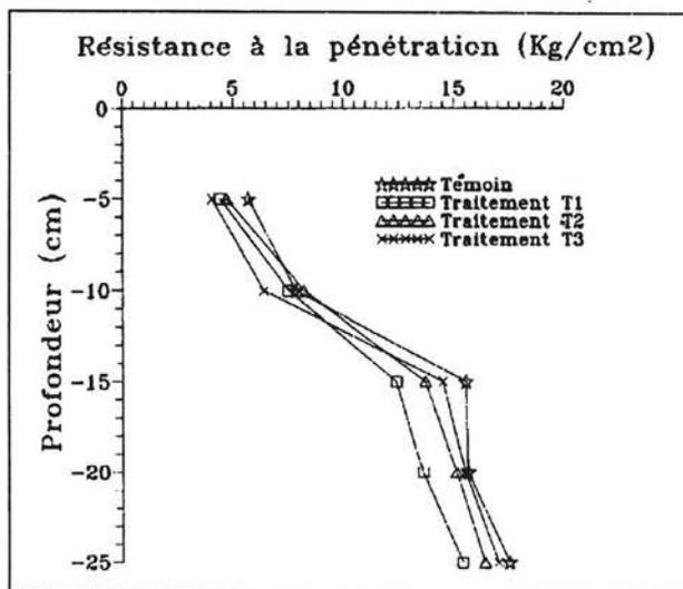
Figure 10. Profil moyen de la résistance à la pénétration des trois traitements T1, T2, T3, avant récolte.
