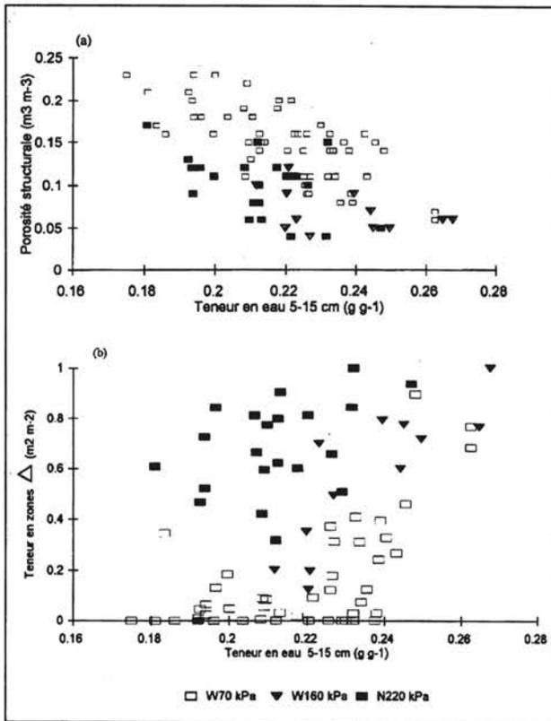
Figure 2. Effet de l'humidité entre 5 et 15 cm sur la porosité structurale à 10 cm (a) ou le pourcentage de zones  $\Delta$  dans les 10 cm sous le lit de semences (b) en fonction des caractéristiques des pneumatiques.
