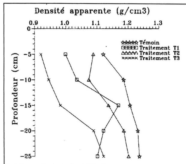
Figure 3. Profil moyen de la densité apparente des trois traitements T1, T2, T3, au milieu du cycle cultural.
