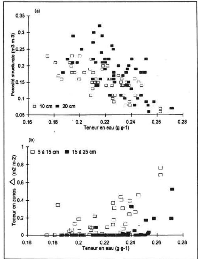
Figure 3. Relations entre l'humidité et la porosité structurale (a) ou le pourcentage de zones  $\Delta$  (b) en fonction de la profondeur lors d'interventions avec pneus larges et pour une pression de 70 kPa.
