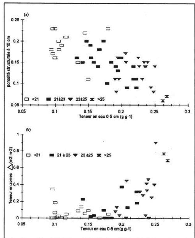
Figure 4. Effet de la teneur en eau des cinq premiers centimètres sur la porosité structurale à 10 cm (a) ou sur le pourcentage de zones  $\Delta$  dans les 10 cm sous le lit de semences (b) pour différentes classes d'humidité de la couche 5-15 cm.
