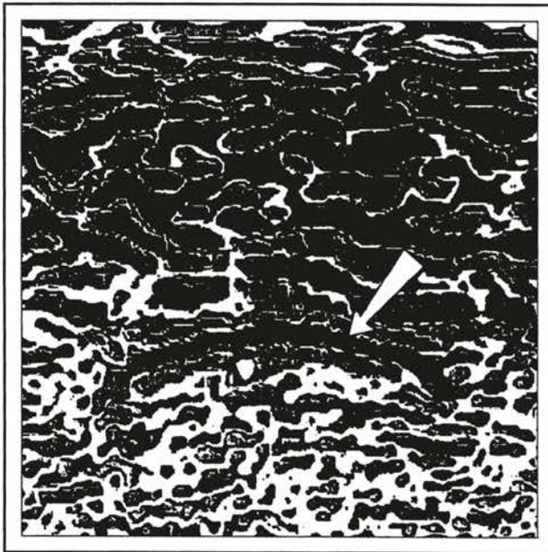
**Figure 8.** Section radar (SIR.10) avec l'image de la signature d'un drain (flèche) en forme de croissant.
