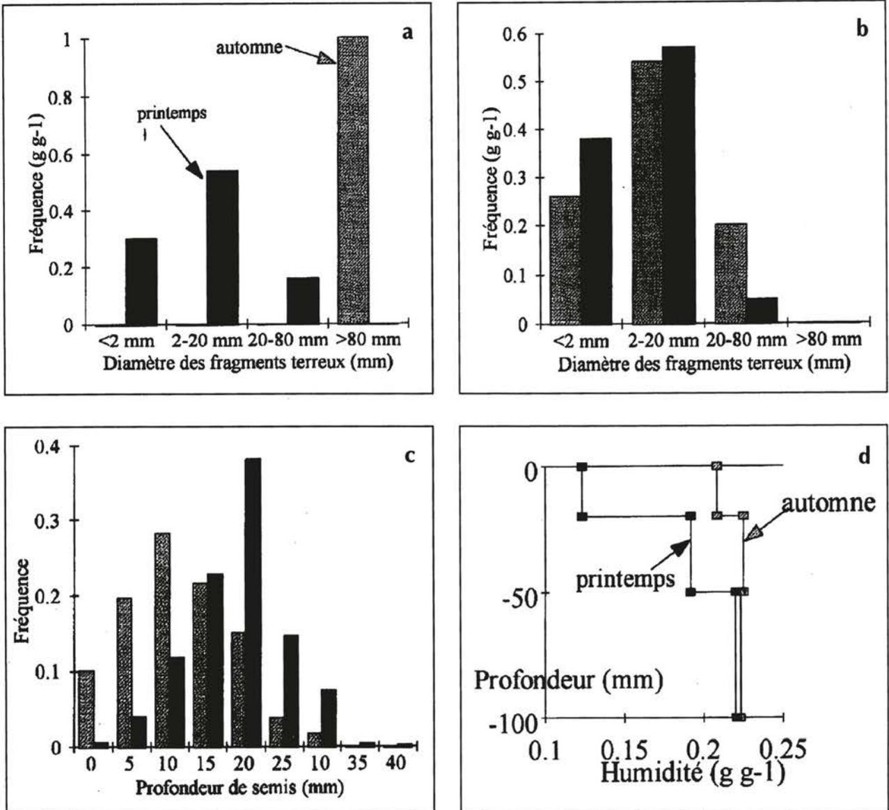
**Figure 1.** Distribution de la taille des fragments terreux avant le passage du semoir (a) et après le passage du semoir (b), distribution des profondeurs de semis (c), et profils hydriques le jour du semis (d) en fonction de la date de préparation du lit de semences (sol de limon moyen, avril 1992 ; Richard, non publié).
