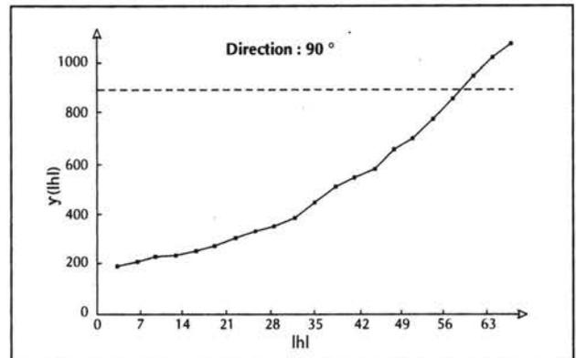
**Figure 3b.** Semi-variogramme, modelé en bourrelet, direction perpendiculaire au bourrelet.
