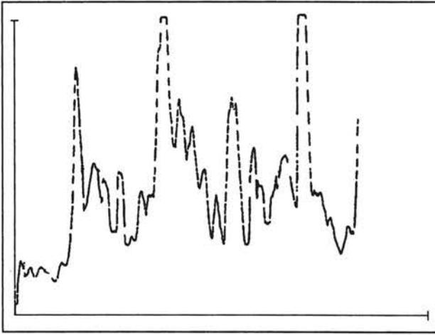
**Figure 7.** Sortie sur table traçante : variations de résistivité du sol en fonction de la position du tapis de mesure (matériel Elcore de Selva électronique).
