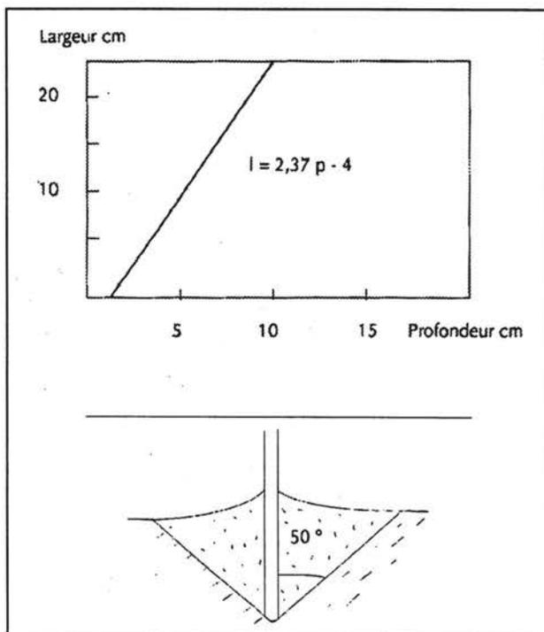
Figure 2. Lien entre la largeur écartée et la profondeur de travail.
