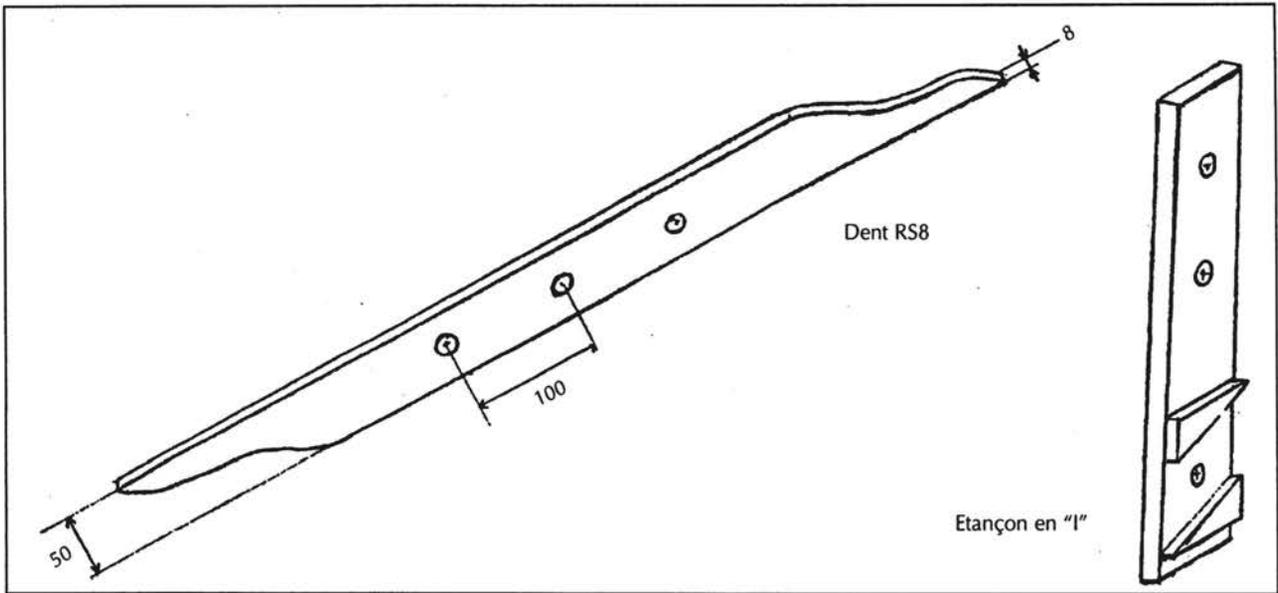
Figure 1. Schéma de la dent RS8 et de l'étauçon en « I ».
