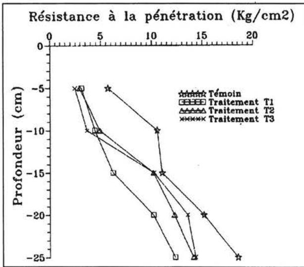
Figure 8. Profil moyen de la résistance à la pénétration des trois traitements T1, T2, T3, après semis.
