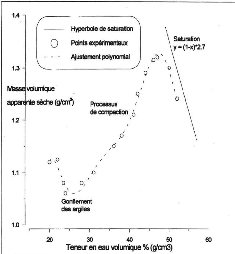
Figure 2. Test de sensibilité au compactage dynamique (Proctor modifié) sous contrainte dynamique de  $140 \text{ kJ. m}^{-3}$ .
