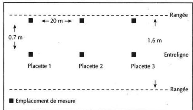
**Figure 1.** Dispositif de mesures de sonde.
