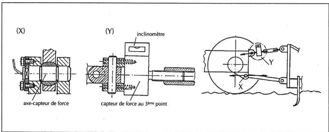
Figure 2. Méthode utilisée pour la mesure de l'effort de traction dans le cas des outils portés.
