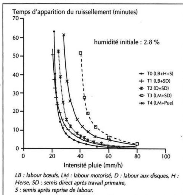
**Figure 2.** Mesure de l'infiltrabilité du sol en milieu réel dans le nord de la Côte d'Ivoire (Pes de Tchololevogo) sous différents modes de gestion du sol. Temps de submersion en fonction de l'intensité de l'averse (d'après Chopart, 1995).
