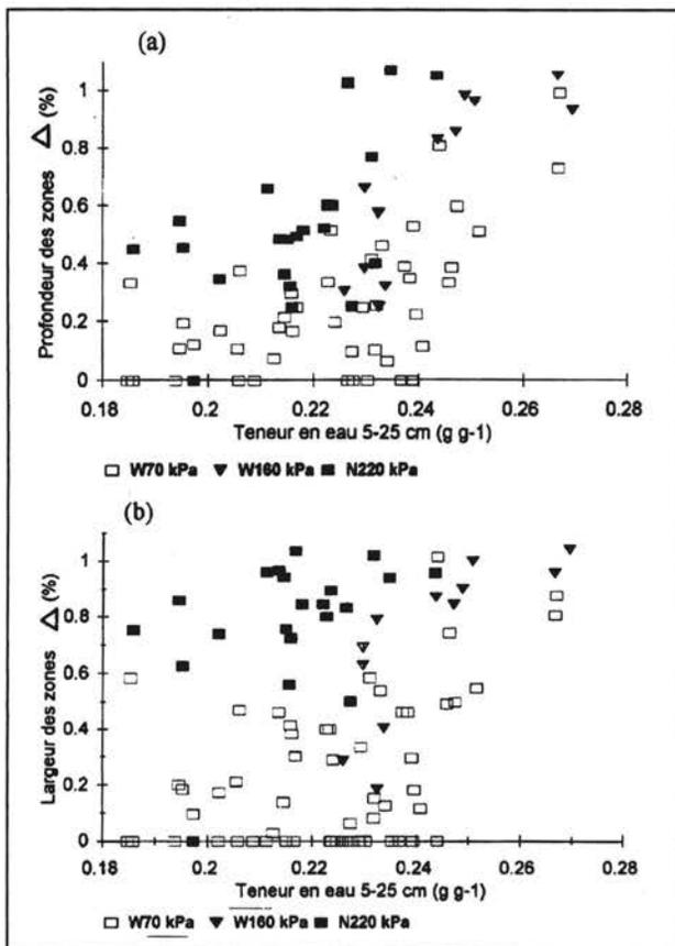
**Figure 5.** Épaisseur et largeur maximales des zones  $\Delta$  à l'aplomb des roues en fonction de l'humidité de l'horizon H5. Pour l'épaisseur, les résultats sont exprimés en % de l'épaisseur de l'horizon H5 mesuré sur chaque profil cultural, pour la largeur, les résultats sont exprimés en % de la largeur du pneumatique.
