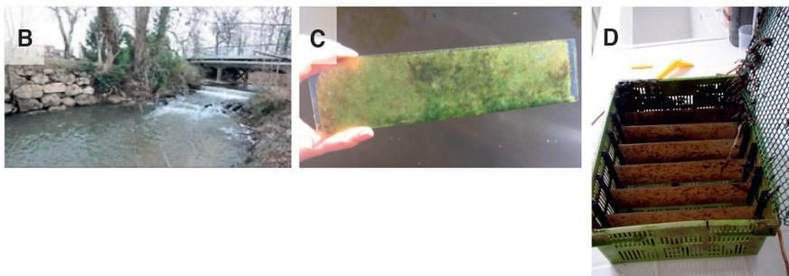
**Figure 5.8.** A) Localisation géographique des différents points de prélèvements sur la commune de Marcillac (entourés en rouge). Photographie de B) la Livenne, C) d'une lame recouverte de biofilm et D) d'une cage contenant ces lames colonisées après un mois d'immersion.
