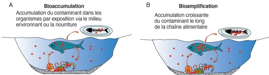
Figure 5.4. Schéma conceptuel du principe de A) bioaccumulation et de B) bioamplification des contaminants (figurés par les points rouges).
