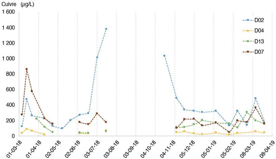
**Figure 2.5.** Évolution au cours du temps de la concentration totale en cuivre sur quatre sols viticoles dans l'appellation côtes-de-Blaye : D2 ( $Cu_{tot} = 101$  mg/kg ; pH = 5,3 ; MO = 0,8 %) ; D4 ( $Cu_{tot} = 16$  mg/kg ; pH = 7,4 ; MO = 2,1 %) ; D7 ( $Cu_{tot} = 197$  mg/kg, pH = 6,8 ; MO = 1,4 %) ; D13 ( $Cu_{tot} = 161$  mg/kg, pH = 6,5 ; MO = 1,1 %).
