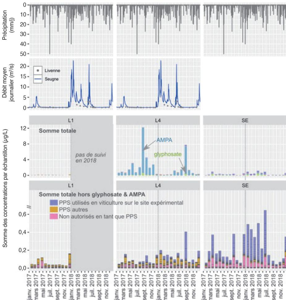
**Figure 3.9.** Évolution des précipitations, des débits et de la somme des concentrations par échantillon en fonction des points et dates de suivi. Pour les sommes des concentrations par échantillon, seules les valeurs supérieures à la limite de quantification sont prises en compte ici.
