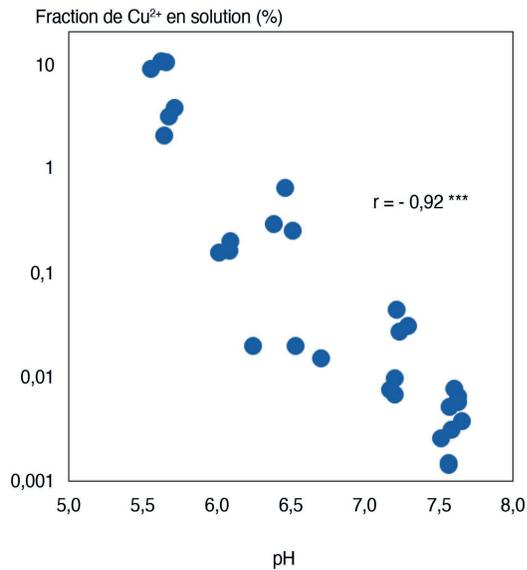
**Figure 2.4.** Relation entre le pH et la fraction ionique de cuivre mesurée dans l'eau porale de dix sols viticoles de l'AOP Pessac Léognan (Cornu *et al.*, 2020).
