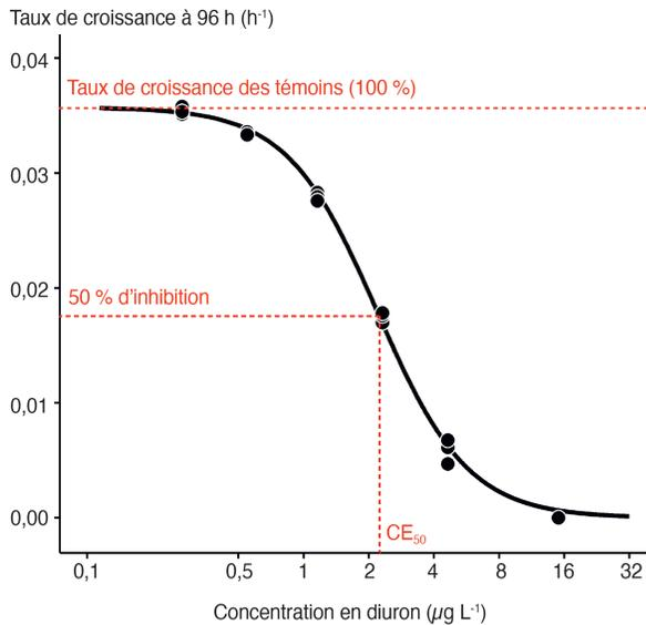
**Figure 6.3.** Exemple de courbe concentration-réponse obtenue avec le diuron pour l'espèce *T. lutea*. Les points représentent les triplicats expérimentaux pour chaque concentration testée. En rouge sont représentés par des lignes en pointillé le taux de croissance des témoins (100 %) et le taux de croissance pour 50 % d'inhibition (en ordonnées), ainsi que la concentration correspondante en diuron (en abscisse) reportée via la courbe-concentration-réponse modélisée (courbe noire).
