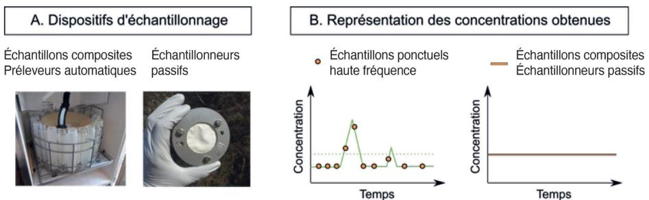
**Figure 3.10.** A) Dispositifs alternatifs d'échantillonnage et B) Représentation schématique des concentrations obtenues : en principe, la concentration moyenne obtenue avec des échantillons ponctuels haute fréquence est la même que celle obtenue avec des échantillons composites asservis au temps ou des échantillonneurs passifs.
