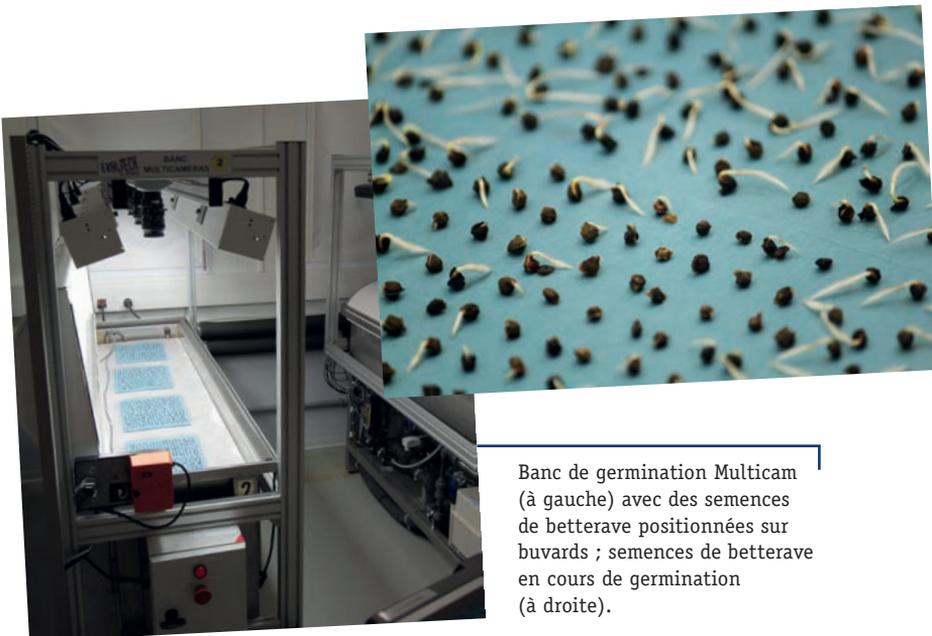
Banc de germination Multicam (à gauche) avec des semences de betterave positionnées sur buvards ; semences de betterave en cours de germination (à droite).
