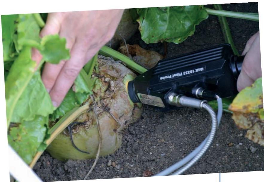
Sonde Plant probe (ASD) utilisée pour les tests exploratoires de la mesure de la richesse.
