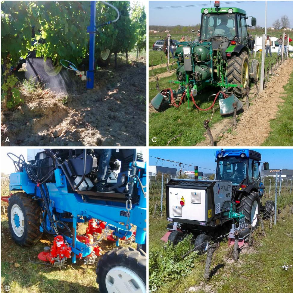
**Figure 1-6-2. A : application de désherbants chimiques sous le rang ; B : houes rotatives montées sur enjambeur ; C : machine de désherbage thermique au gaz propane ; D : prototype de désherbeur électrique. © Christophe Gaviglio, IFV81.**
