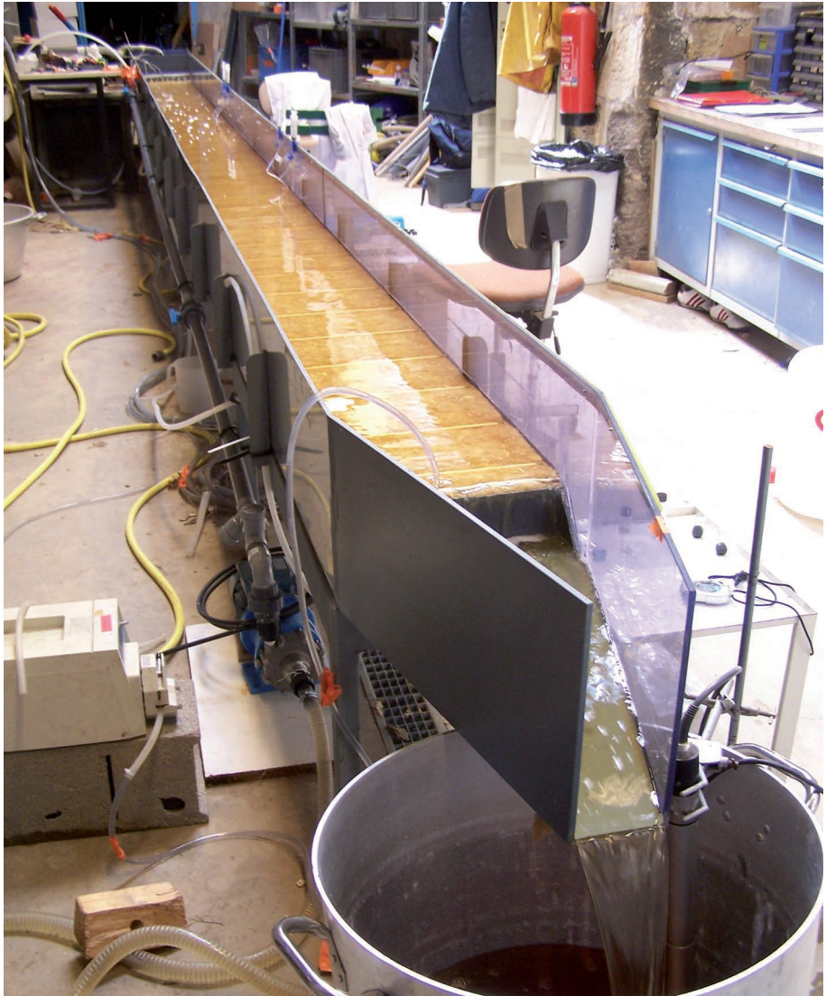
Figure 2.14. Canal expérimental, de 8 m de long et de 40 cm de large, conçu et construit à l'Irstea de Lyon en 2000 (Margoum, 2003) afin de réaliser des expérimentations en conditions dynamiques contrôlées se rapprochant d'un écoulement naturel et d'observer l'influence de la nature du substrat (richesse en matière organique et surface de contact) et des conditions hydrodynamiques sur la rétention des pesticides.
