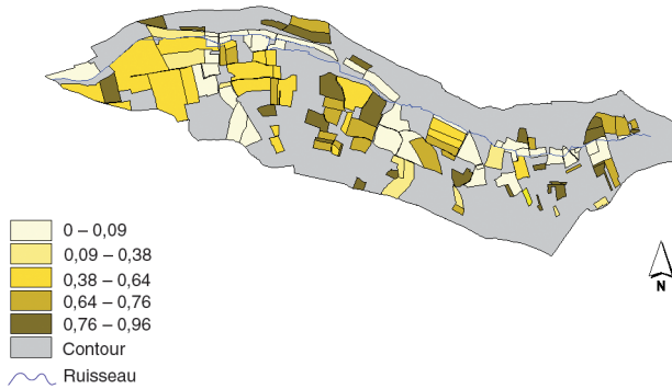
Figure 2.13. Contribution des parcelles traitées avec de l'atrazine au flux d'atrazine à l'exutoire du petit bassin-versant, estimée par le modèle (1995-1997). La légende précise le score de contribution spécifique modélisé attaché à chaque parcelle ; la portée de l'échelle (ici, de 0 à 0,96) et les classes sont autodéterminées par le modèle (Dubernet et al. , 2006).
