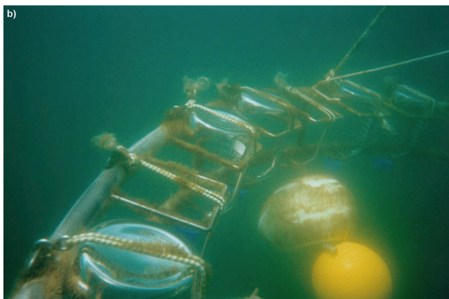
Figure 4.35. (a) Mise en place de la structure sur laquelle sont fixés les microcosmes (© Stachowski-Haberkorn, Ifremer) ; (b) Vue sous-marine des microcosmes fixés à la structure immergée in situ (© Stachowski-Haberkorn, Ifremer). Protocole adapté d'après de la Broise et Palenik (2007).
