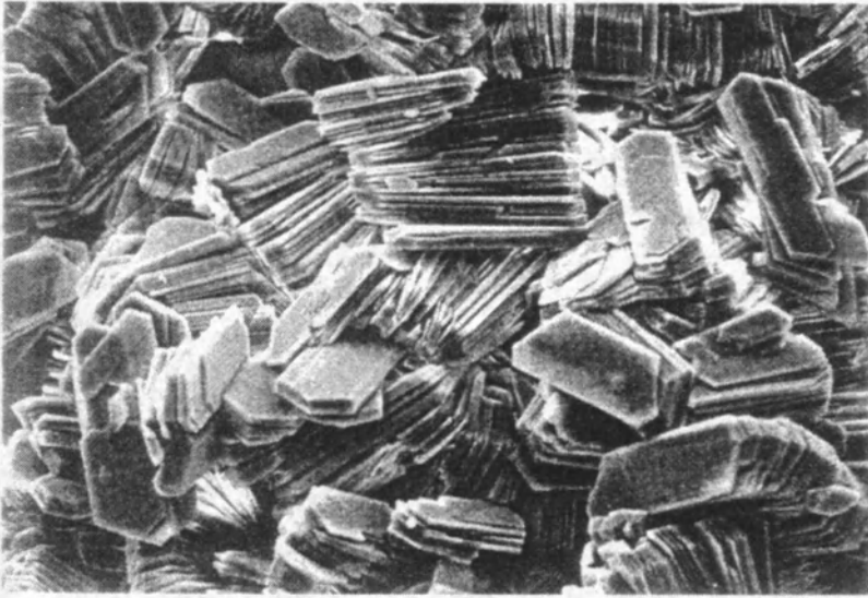
Fig. 2 - Cliché de kaolinite, obtenu par microscopie électronique à balayage. La rigidité des cristaux en forme de plaquettes et leur mise en ordre à l'échelle locale, sous forme d'empilements de plaquettes, apparaît clairement.
