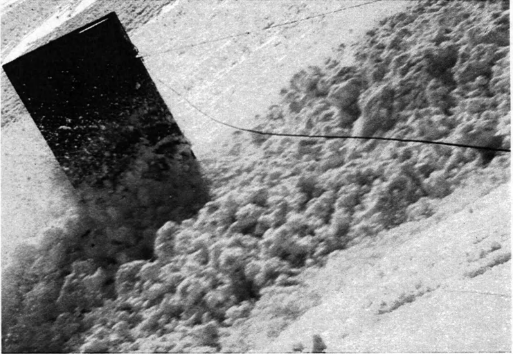
Fig. 3 - Avalanche coulante (site expérimental du Lautaret, Hautes-Alpes). On distingue sur la photographie une structure en forme d'aile, qui servait à l'instrumentation du site. On notera l'écoulement sous forme de boules de neige. On notera également que l'aile ne produit pas d'effet significatif sur la hauteur d'écoulement. Document Cemagref (cliché O. Marco).
