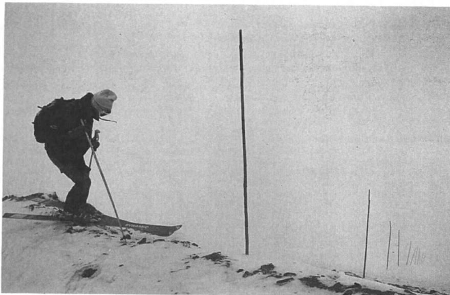
Figure 1 : mesure de hauteur de neige sur les pentes-test.
